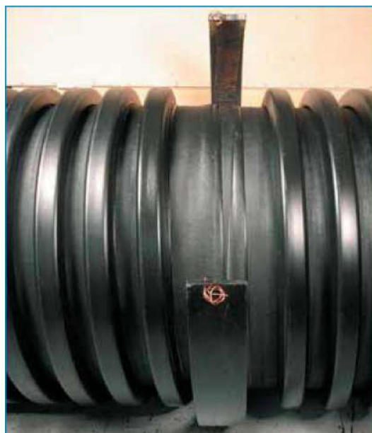
Фигура 10.7: Местоположение на тръбите от край до край и опаковане на EF
